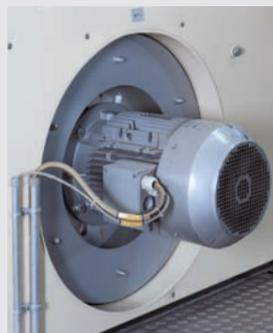
Hochtemperaturfette zur Schmierung von mechanisch und thermisch hochbelasteten Wälz- und Gleitlagern, z.B. Wälzlager in Abluftventilatoren von Trocknern
