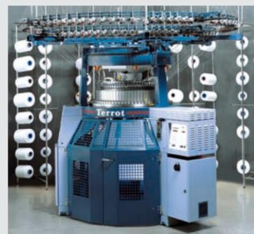
Vollsynthetische Nadel- und Platinenöle mit extrem hohen Anforderungen an Auswaschbarkeit und Schmierleistung auf Großrundstrickmaschinen
