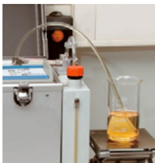
Števec delcev tip Pic 9100, ki ga uporablja podjetje Zeller+Gmelin.
